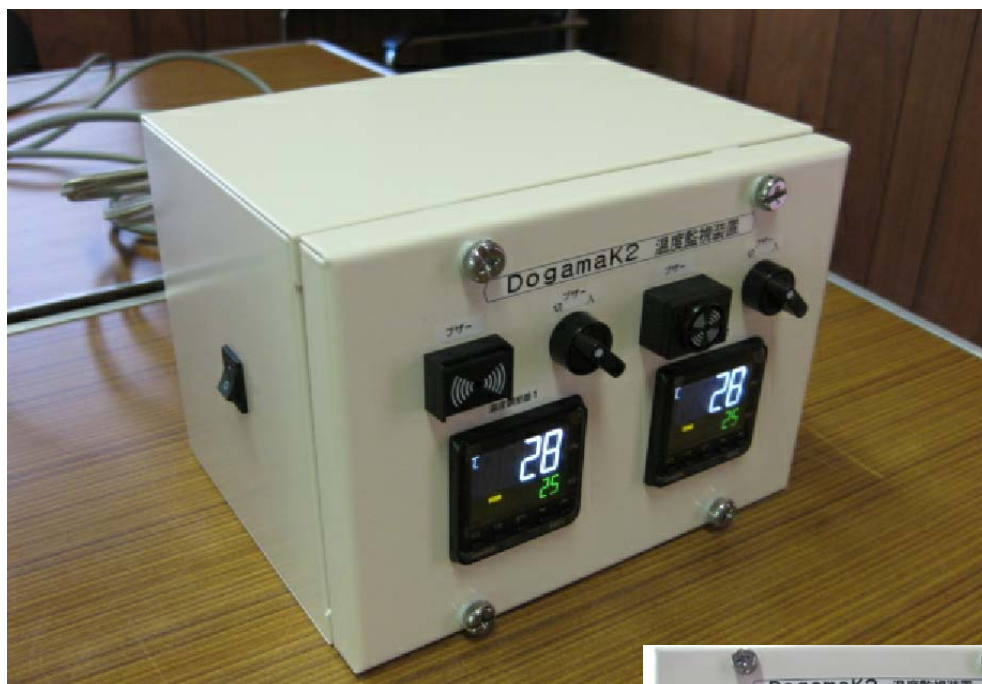
小型温度表示器(卓上型) サイズ: 200(W)x160(D)x150(H)
